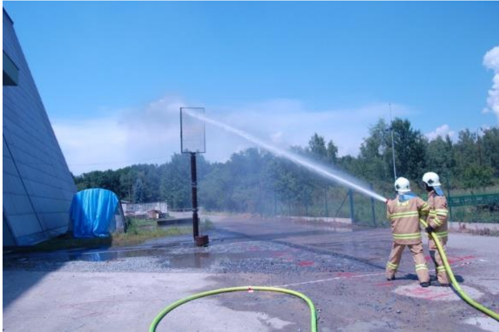
Obr.2 Ruční aplikace vodního proudu na zkušební zařízení pod napětím 400 kV
