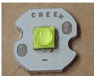
Obr. 11 LED CREE XPG-3 - mikro-optika je implementována přímo na čip
